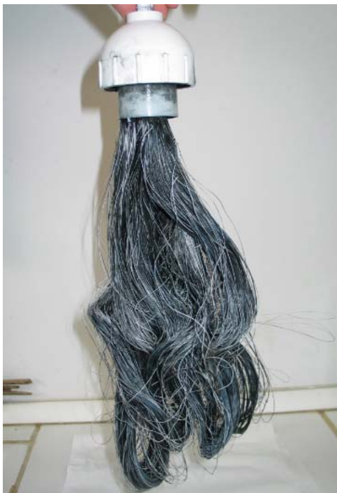
Σχήμα 7. Φωτογραφική απεικόνιση των μεμβρανών μικροδιήθησης κοίλων ινών κατά τη λειτουργία με αιώρημα ενεργού άνθρακα. Ο χρωματισμός των μεμβρανών οφείλεται στο σχηματισμό του στρώματος επικαθήσεων.
