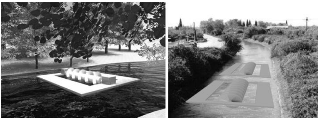
Σχήμα 9. Επιπλεύουσες κοχλιωτές διατάξεις ανάκτησης της κινητικής ενέργειας φυσικού ή τεχνητού υδατορρέυματος
