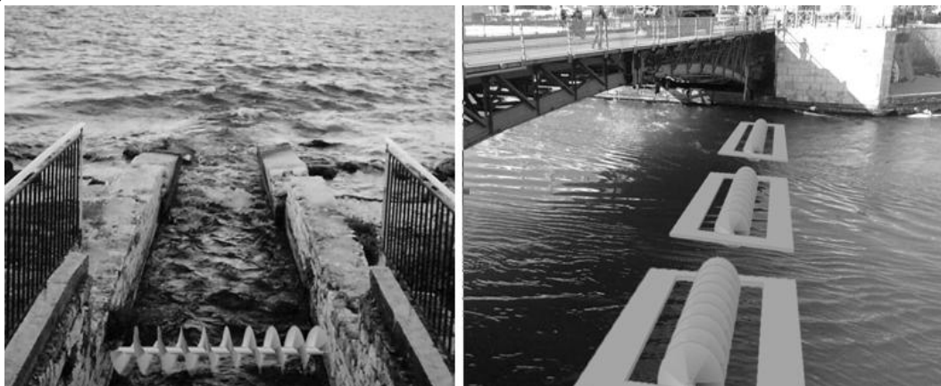
Σχήμα 10. Προτάσεις για κοχλιωτές διατάξεις ανάκτησης της κινητικής ενέργειας στην Κεφαλληνία και στον Εύριπο.
