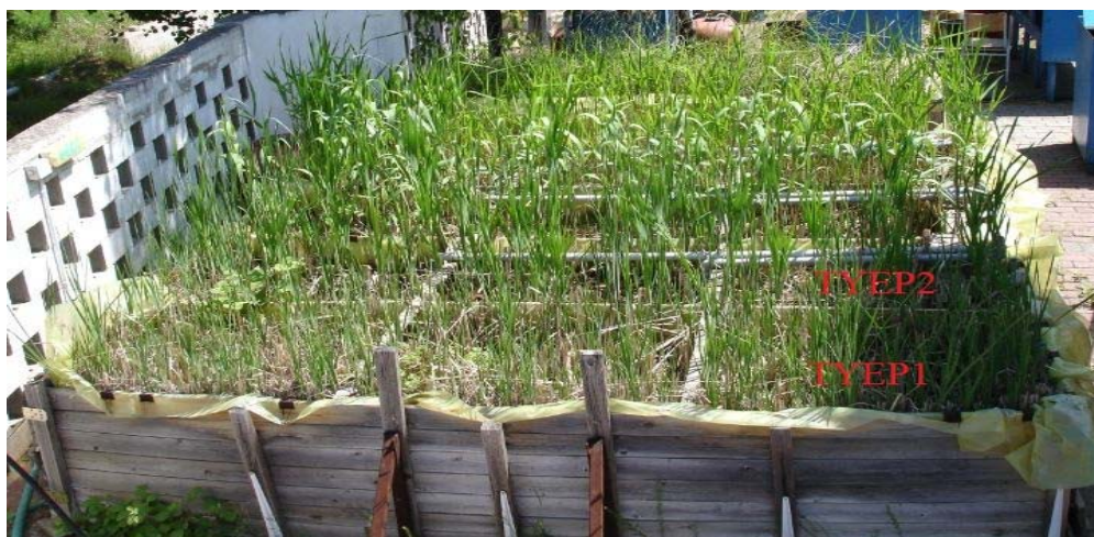
Εικόνα 2. Πιλοτικές Μονάδες ΤΥΕΡ για την επεξεργασία ΥΑΕ
