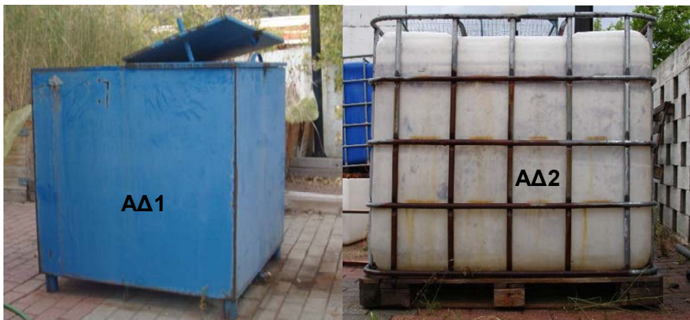
Εικόνα 1. Ανοικτές μη-αεριζόμενες με τεχνητό τρόπο δεξαμενές για την προεπεξεργασία ΥΑΕ
