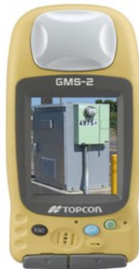
Εικόνα 2: Ο φορητός δέκτης GPS για GIS της TOPCON με ακρίβεια μικρότερη του 1 μ. που χρησιμοποιήθηκε για την αποτύπωση στοιχείων του δικτύου της Κω.
