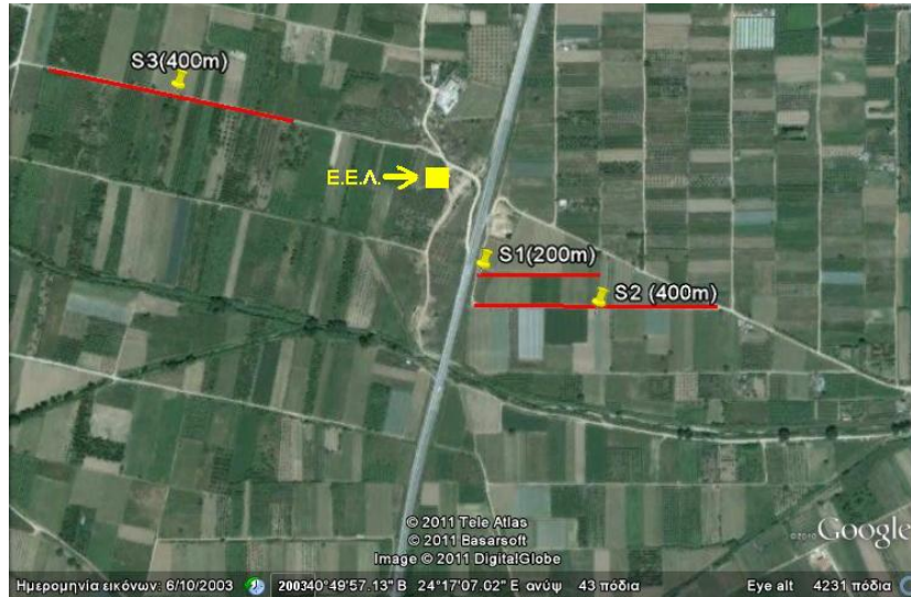
Σχήμα 6: Θέση ηλεκτρικών τομογραφιών S1,S2 και S3 που πραγματοποιήθηκαν στην περιοχή της Νέας Περάμου (Κατιμάδα, 2011).
